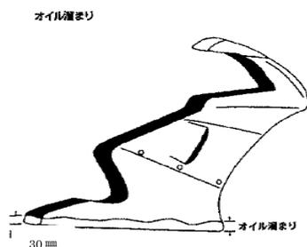
7-3-10-5-2 フェアリング下部には、直径 20 mm (許容誤差+ 5 mm) の水抜き用の孔を最小 1 個設けなければならない (孔は 2 個までとする)。
